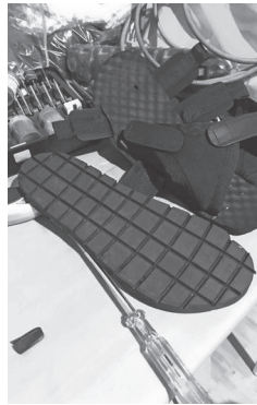
Montado Bandas + Plantilla
